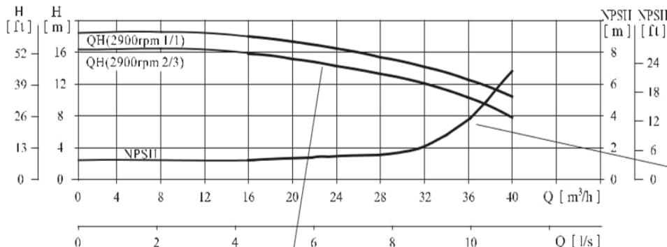
График характеристики NPSH (высоты с жидкости под ввающим патрубком) представляет с усредненную ха ристику, действи ную для всех исп льзований. При выборе мостров насоса не димо прибавлять менее 0,5 м в кач запаса.
