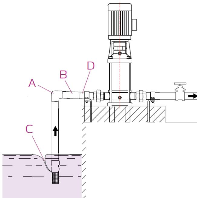
Всасывающий трубопровод должен быть полностью герметичен и соответствующего размера для условия всасывания. Когда уровень жидкости
