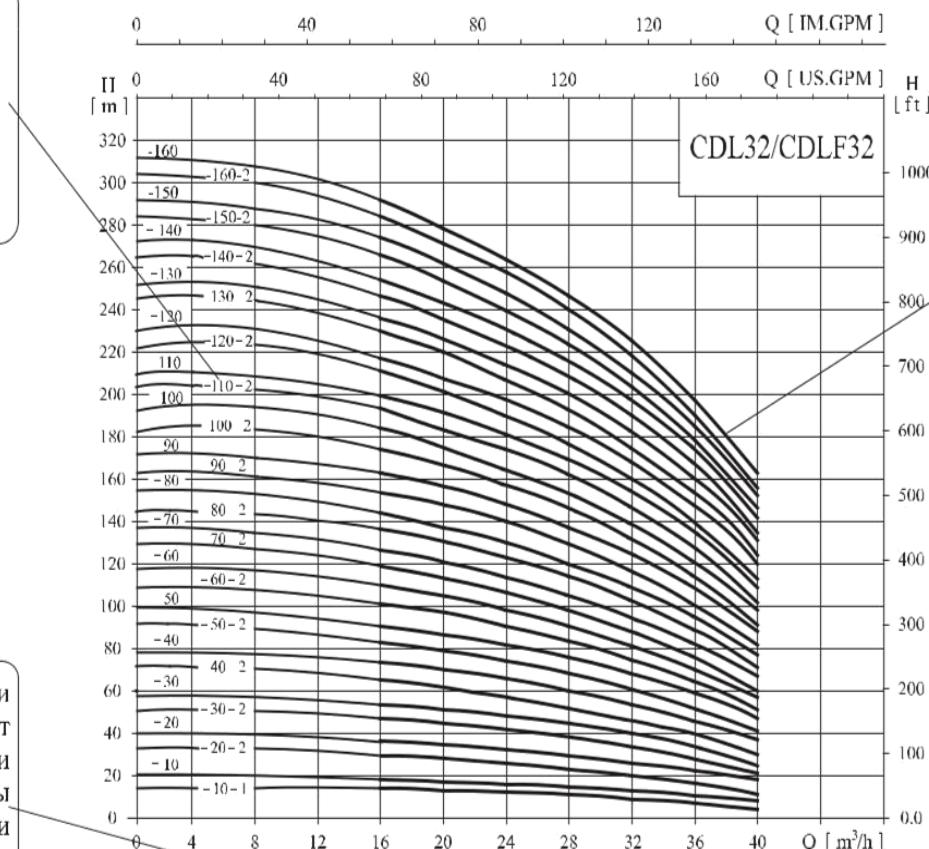
График характеристики «Q-H» соответствует насосу. Графики, уные выделенными ями, показывают мендуемую област плуатации с оп льным КПД.
