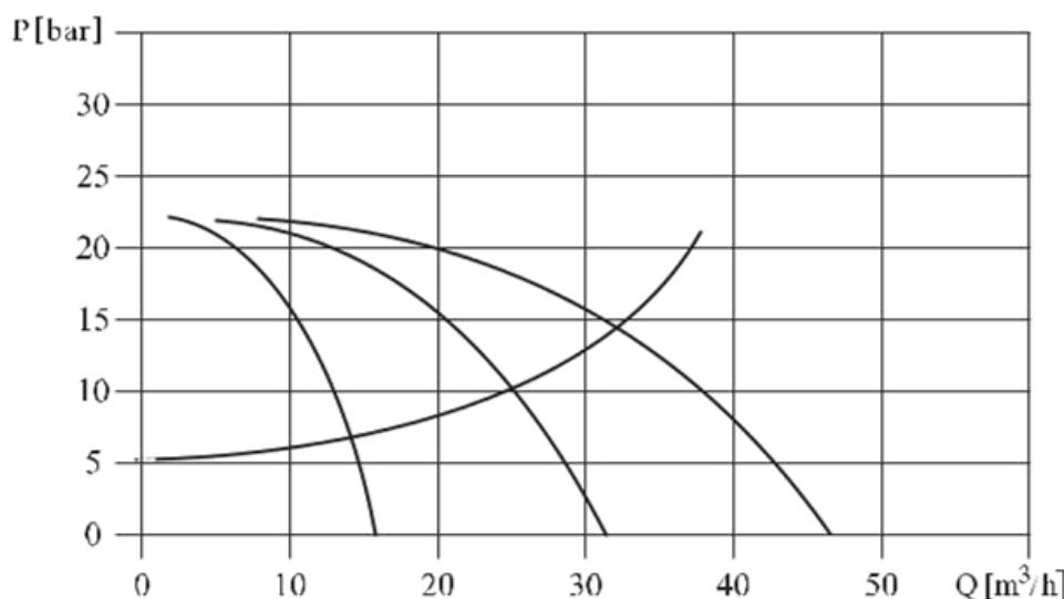
При необходимости, два и более насоса могут быть соединены для параллельной работы.
