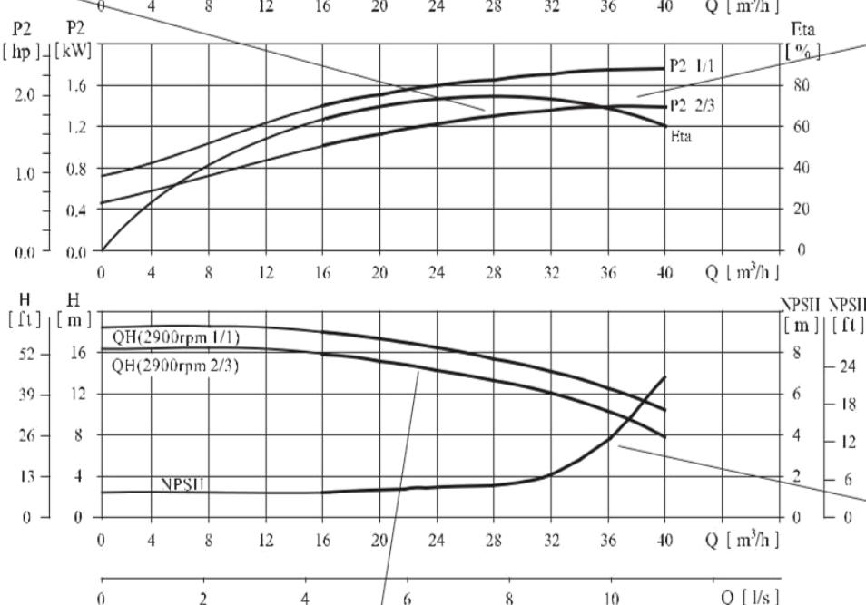
График Eta предста КПД насоса, с у шенным по диа рабочим колесом на 2% ниже, чем зано на графике.
